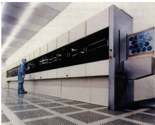
Abb. 2. Vakuumbeschichtungsanlage zur Herstellung magnetooptischer Speicherplatten. Um die erforderliche Reinraumklasse zu erreichen, wird der Raum mit laminar strömender Luft, die durch Filter in der Decke eingespeist und durch einen Lochboden abgeführt wird, belüftet.
